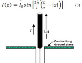
**Fig. 4**.  $\lambda/4$  monopole antenna
